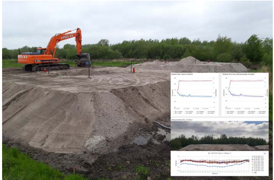
Real-time monitoring van zettingen van twee proefterpen – rechts monitoringsresultaten zakkaken en zettingsmeetslangen voor de proefterp met en zonder verticale drainage.
